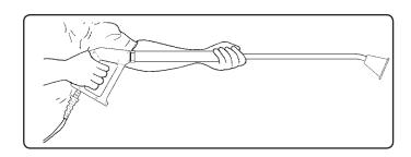
**NOTAS:** 1) Ao ligar a máquina, ocorrerá uma força de reação no gatilho, portanto, segure-o firme.
