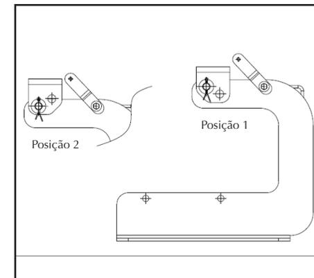
Monte definitivamente o apoio do esticador somente após a fixação da bomba, montagem do protetor interno, polias, correias e motor.
