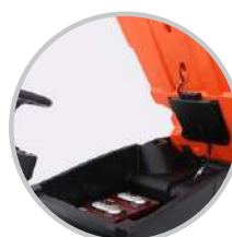
Fácil acesso às baterias por meio da grande abertura do tanque com sistema basculante de pistões a gás de alta qualidade;
